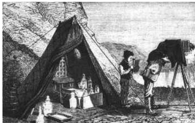
Передвижная фотолаборатория для коллодионного процесса.
