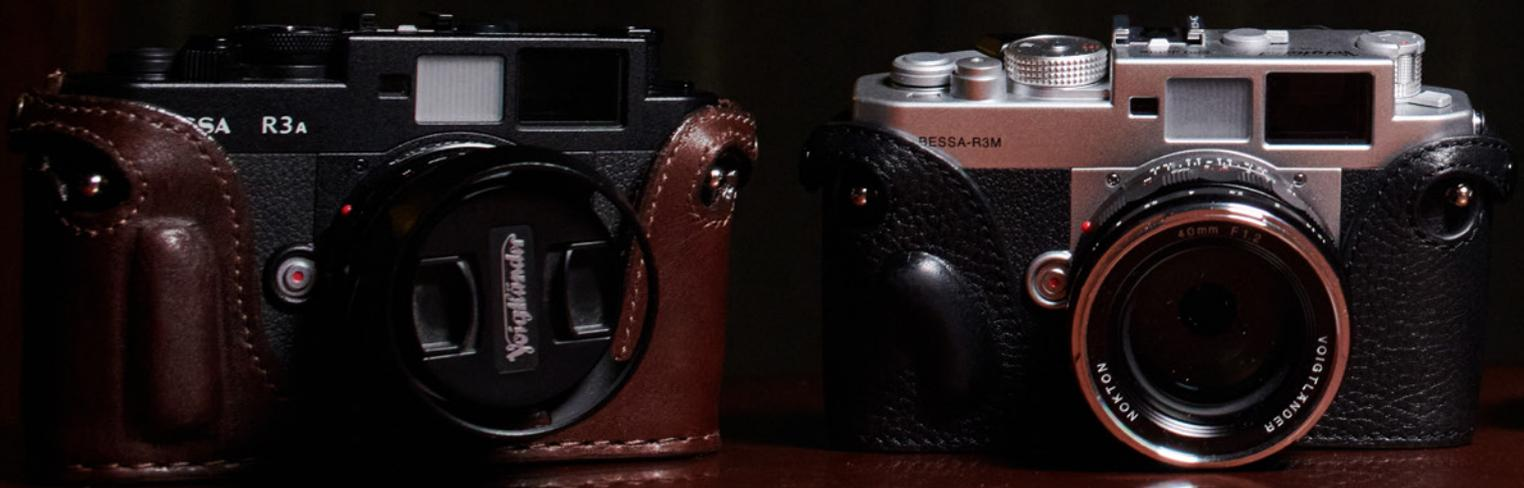
**V**oigtlander Bessa R3a и Voigtlander Bessa R3m – это разновидности одной камеры. Разница в том, что одна из них позволяет снимать с приоритетом диафрагмы и имеет электронный затвор, а вторая не имеет приоритета и с механическим затвором.
